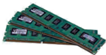
Εικόνα 1.9. Αρθρώματα μνήμης τεχνολογίας DDR
