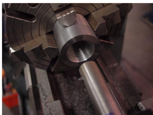
Σχήμα 2.12 Διάφορες διατάξεις συγκράτησης κομματιού και κατεργασίες σε τόρνο ( 2-6-UNC-2B nut , 2-6-UNC-2B nut: threading with boring bar & 2-6-UNC-2B nut: turning on the expanding mandrel by Kirill Ignatyev, Flickr, licenced under CC BY-NC 2.0, Drill, baby, drill! By .dh – Flickr – licenced under CC BY 2.0)
