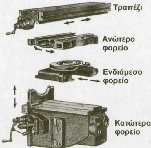
Σχήμα 5.10: Συγκρότημα τραπεζιού οριζόντιας φρεζομηχανής γενικής χρήσης (universal).
