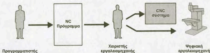
Σχήμα 11.3: Μεταφορά προγράμματος NC στην εργαλειομηχανή.
