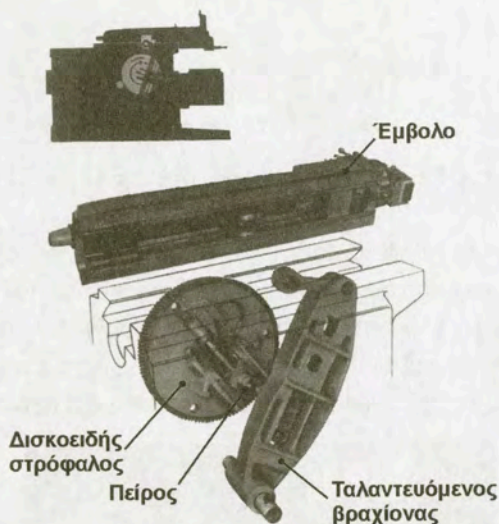
Σχήμα 7.8: Μηχανισμός παλινδρομικής κίνησης του εμβόλου.
