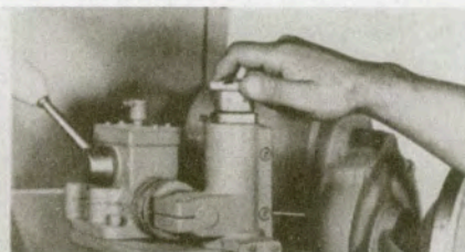
Σχήμα 6.10: Ανανέωση τροχού με εργαλεία από διαμάντι (Α) το εργαλείο εδράζεται σε μία απλή μηχανή συγκράτησης, (Β) υπερκείμενη μηχανή ανανέωσης, όπου το βαθμονομημένο μικρόμετρο ελέγχει την καθοδική πρόωση του διαμαντιού και ο μοχλός μετακινεί εγκάρσια (μπροστά-πίσω) το διαμάντι.
