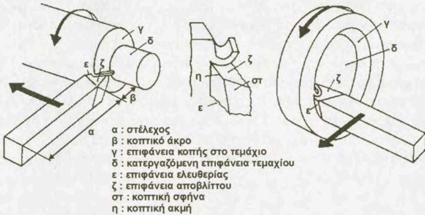
Σχήμα 4.21: Χαρακτηριστικές επιφάνειες και ακμές του εργαλείου και του κατεργαζόμενου τεμαχίου κατά την τórνευση.
