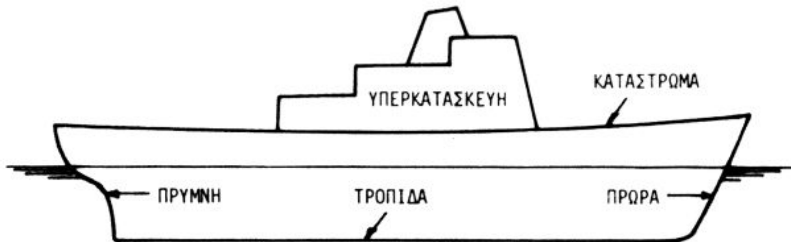
Σχήμα 1.1. Διάμηκες περιγραφή πλοίου
