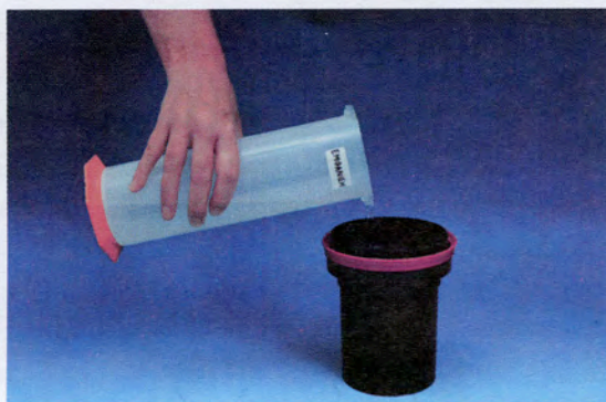
Φωτογραφία 4.18: Αδειάζουμε προσεκτικά στο δοχείο εμφάνισης το εμφανιστικό υγρό
