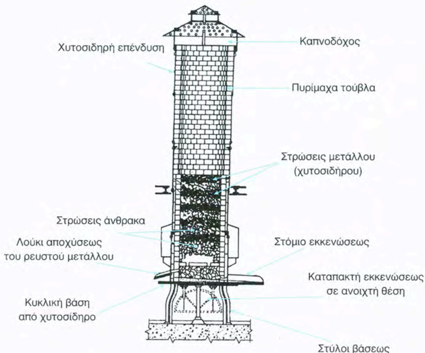
Σχήμα 10.2.1γ Κάμιнос ανάτηξης ή κάμιнос κουπόλα
