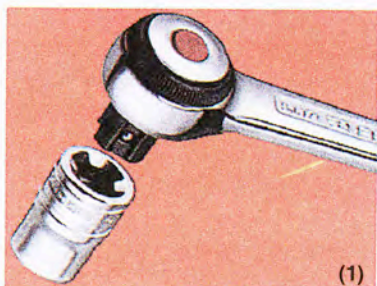
Σχήμα 4.4.2β -1. Καρυδάκι με τη μανέλλα του -2. Σειτ κλειδιών Άλλεν
