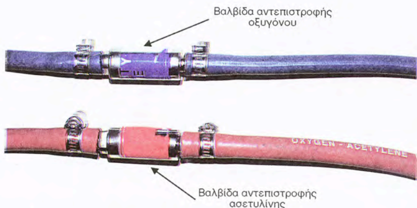
Σχήμα 8.3.6β: Βαλβίδες αντεπιστροφής συνδεδεμένες στους αντίστοιχους ελαστικούς σωλήνες.
