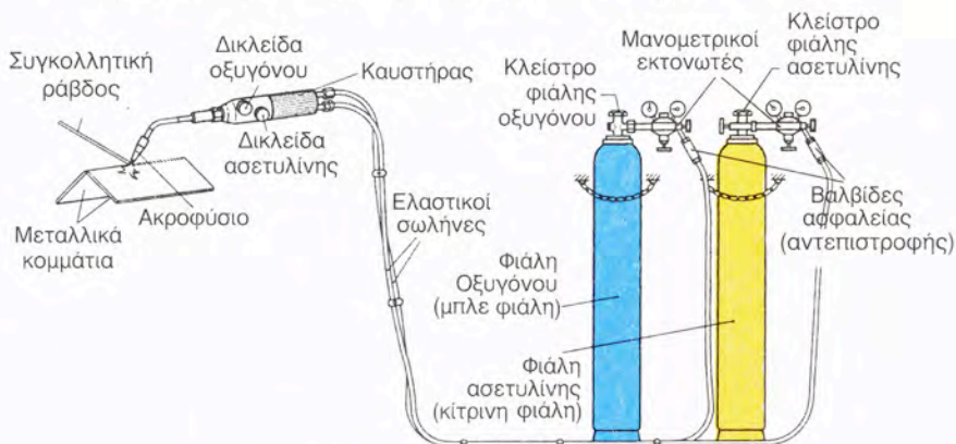
Σχήμα 8.3.16: Συσκευή οξυγονοσυγκόλλησης.
