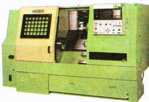
Σχήμα 1.3β: Σύγχρονος προγραμματιζόμενος τóρνος (CNC) και η εργαλειοφόρα κεφαλή του
