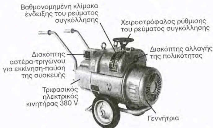
Σχήμα 8.4.5α: Μηχανή ηλεκτροσυγκόλλησης τόξου συνεχούς ρεύματος με γεννήτρια.
