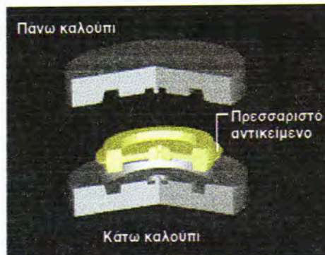
Σχήμα 6.4β. Καλούπι διαμόρφωσης
