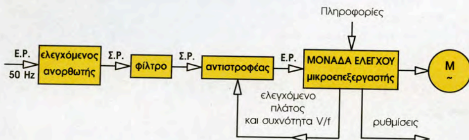
Σχ. 4.47: Δομικό διάγραμμα ηλεκτρονικού ρυθμιστή στροφών.
