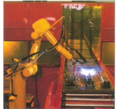
Εικ. 12 Βιομηχανικός ρομποτικός βραχίονας που χρησιμοποιείται για συγκόλληση.
