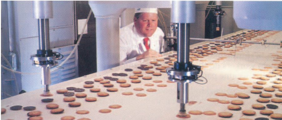
Εικ. 29 Μηχανή παρασκευής μπισκότων η οποία ελέγχεται από ένα μόνο υπεύθυνο
