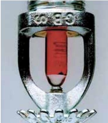
Στη διπλανή φωτογραφία βλέπεις ένα στόμιο από ένα σύστημα αυτόματης πυρόσβεσης. Σε διάφορα σημεία πολλών κτηρίων τα στόμια αυτά τοποθετούνται στην άκρη σωλήνων, που τροφοδοτούνται με νερό ή ειδικό πυροσβεστικό υγρό. Η κόκκινη αμπούλα, που είναι κατασκευασμένη από λεπτό γυαλί και περιέχει ένα υγρό, φράζει την παροχή του νερού. Αν ξεσπάσει πυρκαγιά στο κτήριο, η θερμοκρασία ανεβαίνει πολύ. Τότε η αμπούλα σπάει και το νερό ή το πυροσβεστικό υγρό σβήνει τη φωτιά.
