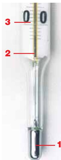
Για να μετρήσουμε τη θερμοκρασία με ακρίβεια, χρησιμοποιούμε ειδικά όργανα, τα θερμόμετρα. Στις εικόνες βλέπεις ένα γνώριμο τύπο θερμομέτρων, στα οποία η ένδειξη δίνεται από κάποιο υγρό. Συνήθως χρησιμοποιούμε υδράργυρο ή χρωματισμένο οινόπνευμα. Τα θερμόμετρα υδραργύρου και τα θερμόμετρα οινόπνευματος μπορεί να περιέχουν διαφορετικό υγρό και να έχουν διαφορετικό σχήμα, έχουν όμως όλα:
