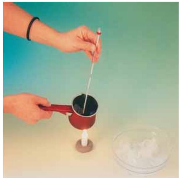
Βάλε στο μπρίκι λίγο νερό και πρόσθεσε δύο μεγάλα παγάκια. Ανακάτεψε καλά με το κουταλάκι. Στερέωσε ένα κερί στο θρανίο σου με πλαστελίνη και άναψέ το. Κράτησε το μπρίκι πάνω από τη φλόγα του κεριού και μέτρα τη θερμοκρασία στο μπρίκι κάθε δύο λεπτά. Ανακάτεψε το νερό όση ώρα μετράς τη θερμοκρασία. Τι παρατηρείς;
