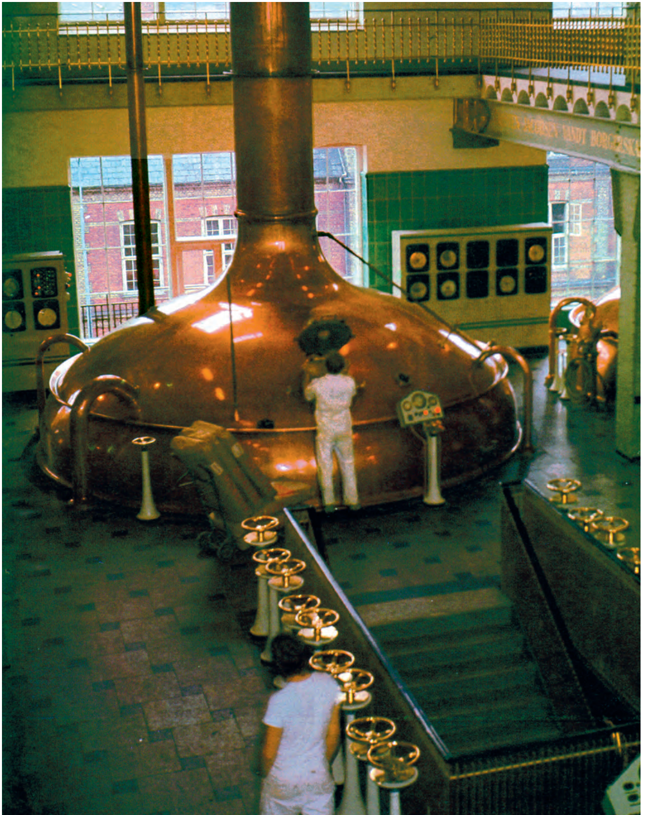
Οινόπνευμα ( C_2H_5OH ) μπορεί να παρασκευαστεί με ζύμωση γλυκόζης. Ειδικά η μπίρα παρασκευάζεται με ζύμωση βύνης από κριθάρι, με προσθήκη λυκίσκου. Η παρασκευή της μπίρας περιλαμβάνει διάφορα στάδια. Το χάλκινο δοχείο που εικονίζεται είναι γνωστό σαν δοχείο παρασκευής μπίρας και αποτελεί βασικό τμήμα της σύγχρονης ζυθοποιίας.
