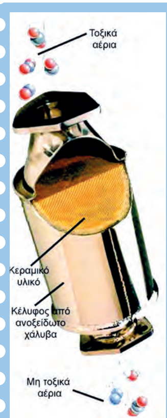
ΣΧΗΜΑ 2.8 Κατασκευαστικές λεπτομέρειες καταλυτικού μετατροπέα. Το κέλυφος είναι από ανοξείδωτο χάλυβα. Ο καταλύτης συνήθως αποτελείται από λευκόχρυσο (Pt) και ρόδιο (Rh) πάνω σε υποστρώμα από κεραμικό υλικό με ενδιάμεση επίστρωση αλουμίνιας (Al 2 O 3 ).
