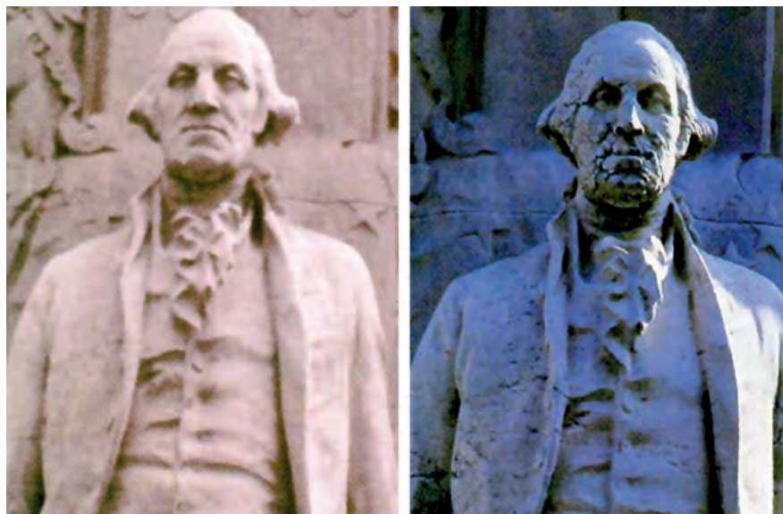
ΣΧΗΜΑ 3.12 Καταστροφή μαρμαρίνων μνημείων ιστορικής αξίας. Η όξινη βροχή μετατρέπει το μάρμαρο ( \text{CaCO}_3 ) σε γύψο ( \text{CaSO}_4 \cdot 2\text{H}_2\text{O} ) - γυψοποίηση του μαρμάρου.
