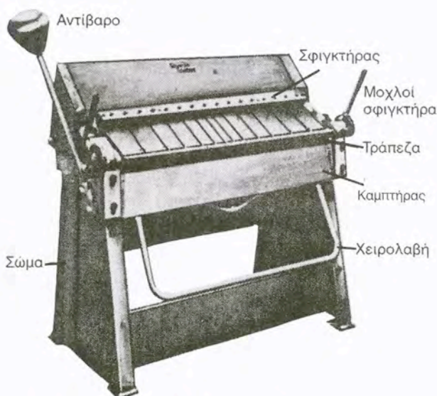
Σχήμα 6.3γ. Καμπτική μηχανή
