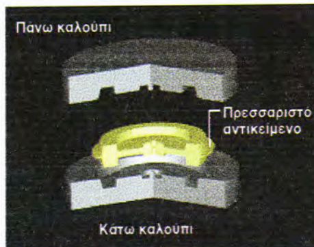
Σχήμα 6.4β. Καλούπι διαμόρφωσης
