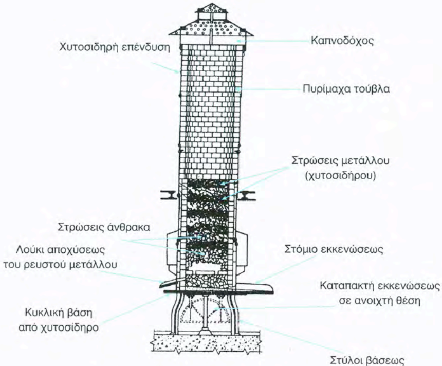
Σχήμα 10.2.1γ Κάμιнос ανάτηξης ή κάμιнос κουπόλα
