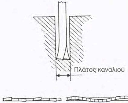
Σχήμα 4.96. Απλή και κυματοειδής αμφοδόντωση
