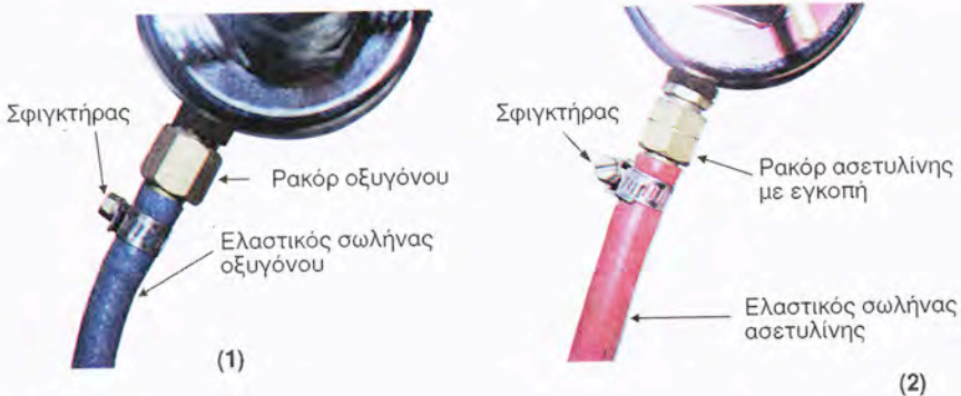
Σχήμα 8.3.5α: 1) Σύνδεση ελαστικού σωλήνα οξυγόνου με τη βοήθεια ρακόρ στο μανομετρικό εκτονωτή. 2) Σύνδεση ελαστικού σωλήνα ασετυλίνης με τη βοήθεια ρακόρ με εγκοπή στο μανομετρικό εκτονωτή.
