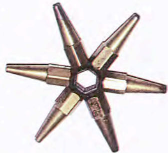
Σχήμα 8.3.7δ: Σειτ ακροφυσίων καυστήρα βιδωμένα στην ειδική βάση τους.
