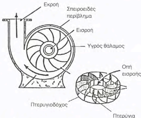
Σχήμα 16.1.1δ. Φυγοκεντρική αντλία ακτινικής ροής
