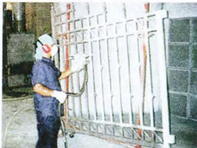
Σχήμα 12.4α. Επιμετάλλωση με πιστόλι
