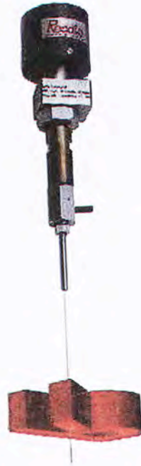
Σχήμα 6.5ε. Κοπή με πίδακα νερού υψηλής πίεσης
