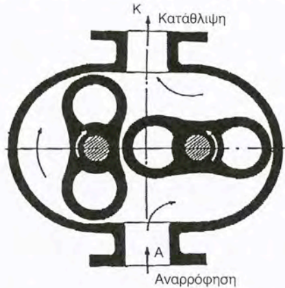
Σχήμα 16.1.1γ. Αντλία με περιστρεφόμενα έμβολα (λοβούς)
