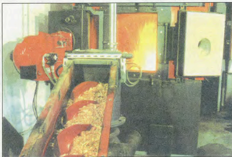
Εικ. 4.24. Καυστήρας ξύλου αυτόματης τροφοδοσίας.
