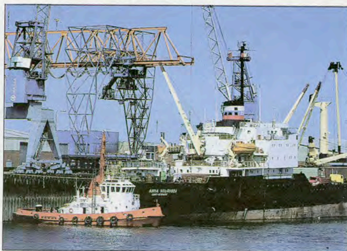
Εικ. 6.24. Φορτοεκφορτώσεις με γερανούς σε αποβάθρα λιμανιού.
