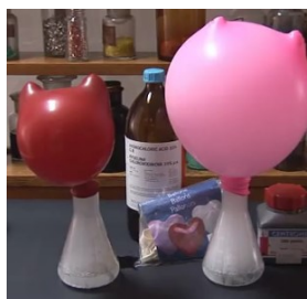
Επίδειξη της αντίδρασης: \text{Zn} + 2\text{HCl} \rightarrow \text{ZnCl}_2 + \text{H}_2(\text{g}) Το αέριο \text{H}_2 που ελευθερώνεται φουσκώνει το μπαλόνι.
