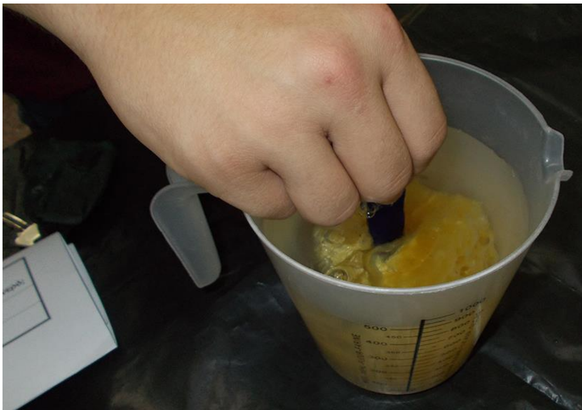
Παραμονή σφουγγαριού για 30' σε δοσομετρητή με 800 gr νερό , πιέζοντάς το με γλωσσοπίεστρο.
