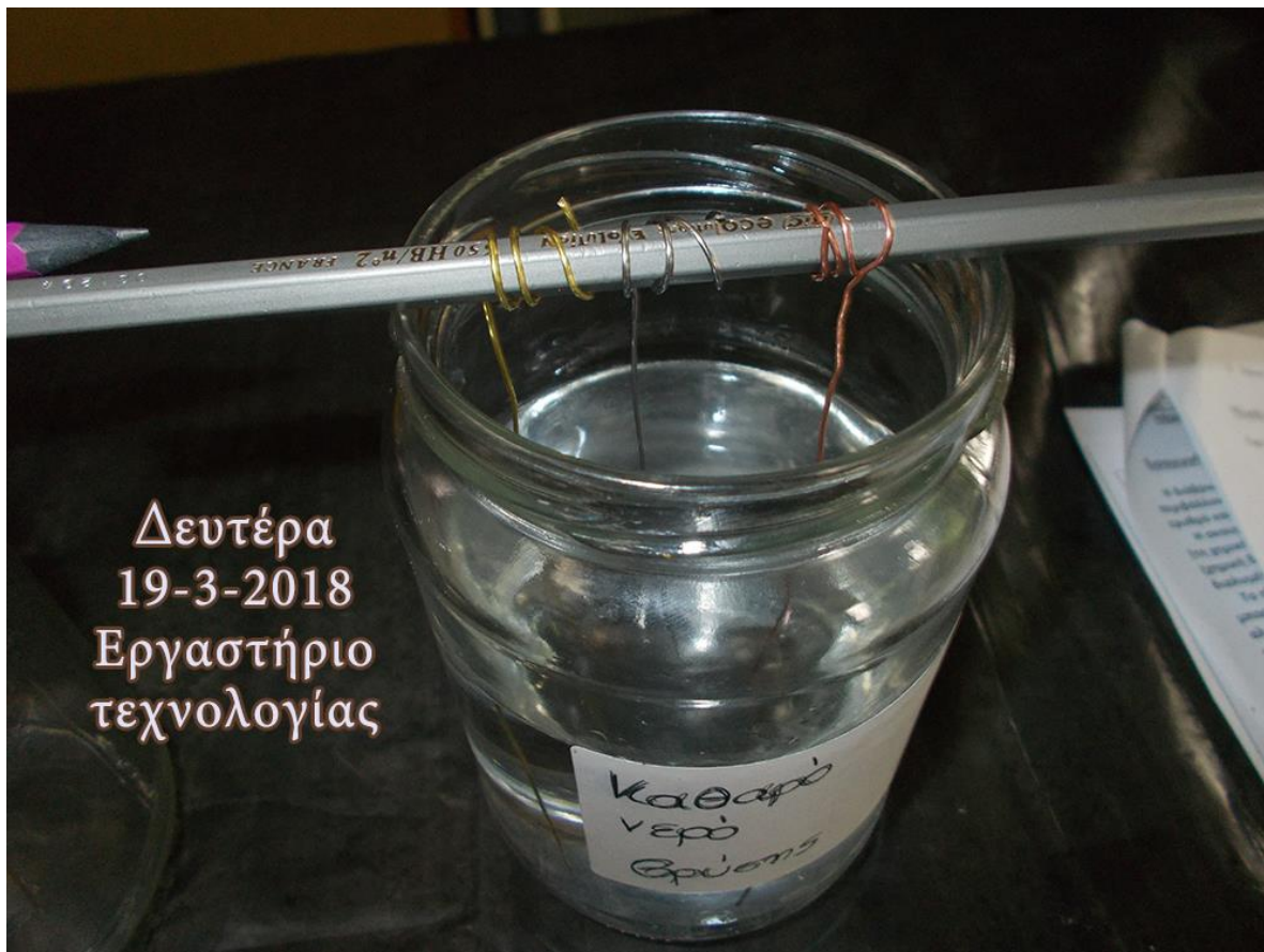
Τοποθέτηση συρμάτων στα βάζα
