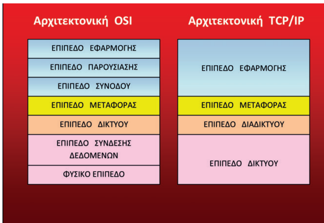
Σχήμα 1.15 Σύγκριση των Αρχιτεκτονικών TCP/IP και OSI
