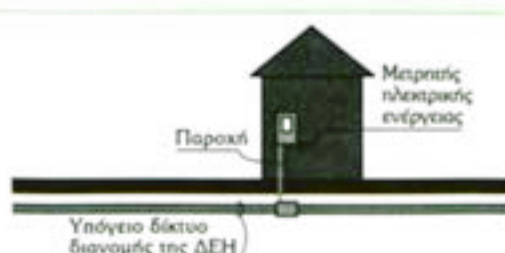
Σχήμα 3.1.β Υπόγεια παροχή
