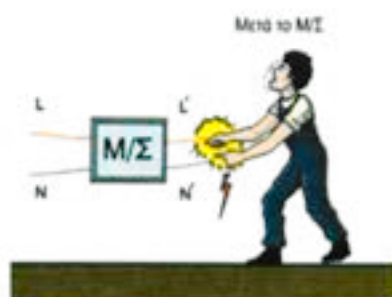
Σχήμα 1.1.4.δ: Συνθήκες ηλεκτροπληξίας σε περίπτωση γαλβανικής απομόνωσης
