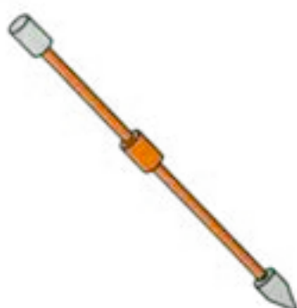
Επιχαλκωμένο με χαλύ- βδινη ψυχή πλεκτρόδιο μορφής ράβδου κυκλικής διατομής.
