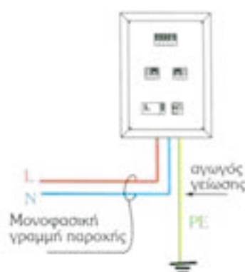
Σχήμα 2.9.2ε: Μονοφασικός πίνακας
