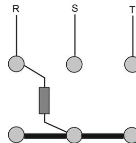
Για να συνδέσουμε τον κινητήρα σε αστέρα γεφυρώνουμε τους τρεις ακροδέκτες και εφαρμόζουμε την τάση στους άλλους τρεις όπως στο σχήμα
