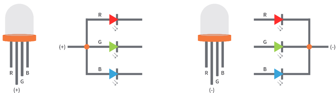
Εικόνα 87: Τύποι RGB LEDs: αριστερά κοινής ανόδου, δεξιά κοινής καθόδου
