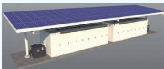
Εικόνα 3.10 Μπαταρίες μεγάλης κλίμακας για αποθήκευση ηλεκτρικής ενέργειας
