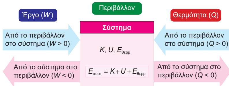
Σχήμα 3.3 Το τελικό βασικό ενεργειακό μοντέλο για ένα σύστημα. Απεικονίζει τις μεταφορές ενέργειας.
