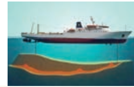
Εικόνα 4.5 Αποτύπωση του βυθού της θάλασσας μέσω χρήσης σόναρ
