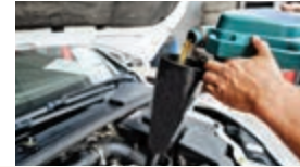
Εικόνα 1.11 Το λιπαντικό προστίθεται στη μηχανή για να μειώσει τις τριβές των μερών της.
